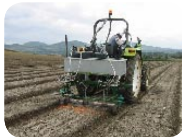
Beflammung der Karottenfelder vor Auflauf – entfernt das Unkraut, das vor den Karotten sprießt
